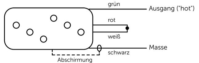
Da jede Spule drei Saiten abnimmt, ist eine Singlecoil-Schaltung wie beim Grand Vintage Humbucker nicht möglich. Machbar wäre aber z.B. eine Parallelschaltung der Spulen oder auch eine Stereo-Schaltung.
