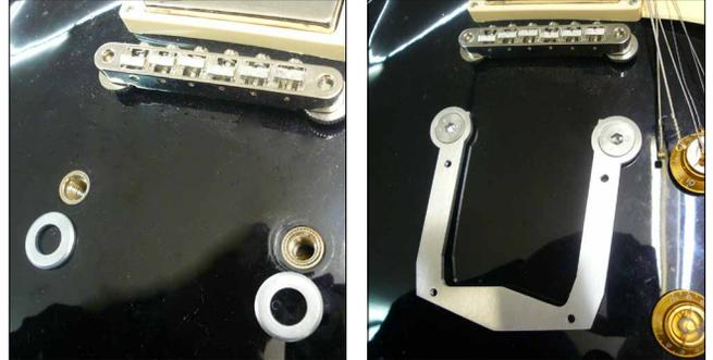
3. Die beiden Unterlegscheiben auf die Gewindehülsen legen und anschließend den Tremola Adapter mit den passenden Montageschrauben montieren. Dabei muss die Senkung der großen Bohrungen nach oben zeigen, so dass die Montageschrauben mit der Oberfläche des Adapters abschließen. **Schrauben fest anziehen!**
