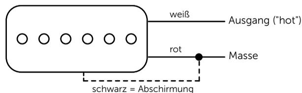
Für die Kombination mit einem Humbucker muss möglicherweise die Phase umgekehrt werden. Dazu werden einfach Rot und Weiß vertauscht. Schwarz (die Abschirmung) bleibt an Masse!
