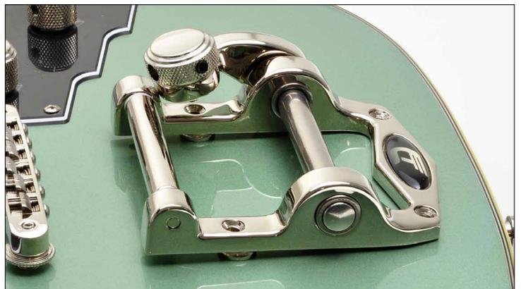
Um den Winkel zu verkleinern, wird das Tremolo „aufgebockt“. Hierzu werden Unterlegscheiben (z.B. das **Duesenberg Washer Set TDSWSN/TDSWSG**) an den beiden vorderen Montageschrauben unter den Rahmen des Tremolos gelegt. An der hinteren Kante liegt das Tremolo auf der Decke auf.
